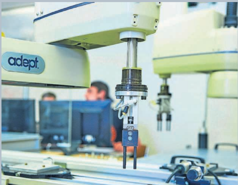
Adept: Dieser Roboter von Omron Adept Technologies ist kein abgespecktes Schulgerät, sondern steht genau so auch in Unternehmen in der Produktion.
