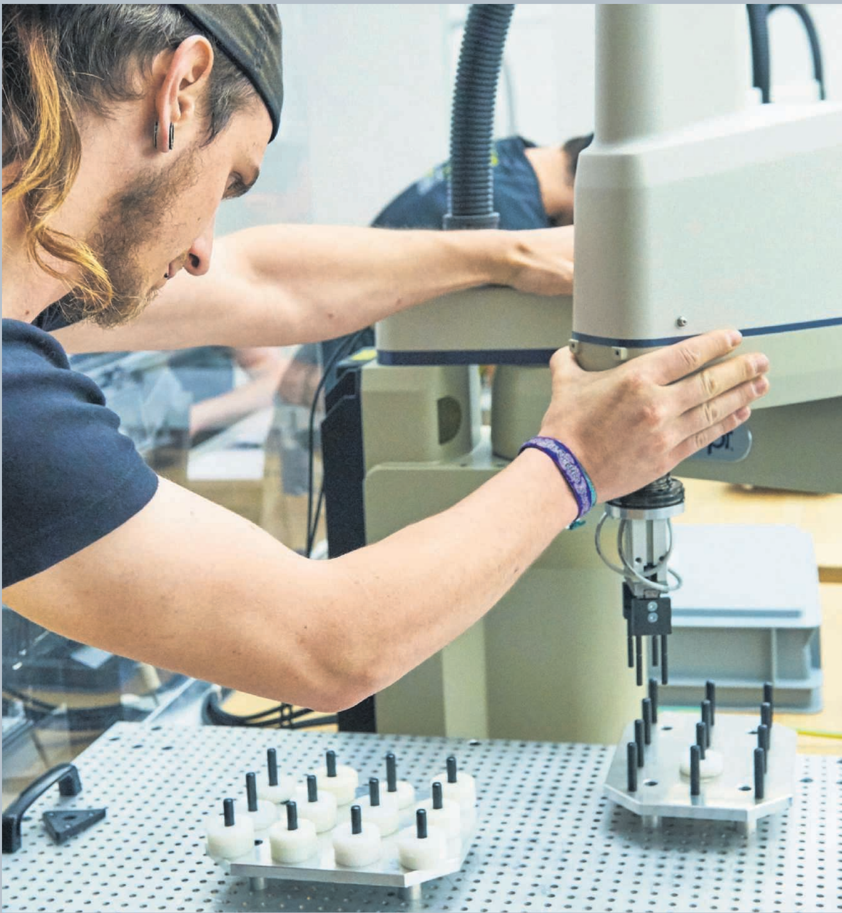
Erste Schritte am Roboter: In der Lektion in Robotertechnik am ZbW in St. Gallen geht es darum, das Aufnehmen und Wiederablegen der weissen Ringe zu programmieren.
